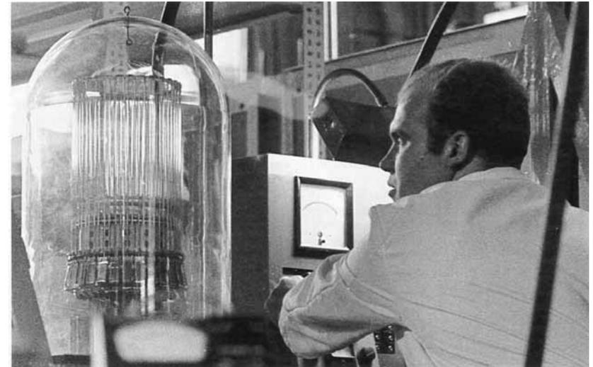
Abbildung 6.11 Prüfung einer 500 kW-Senderöhre, die von AEG/Telefunken für den Kurzwellenbereich entwickelt worden ist. [2]
