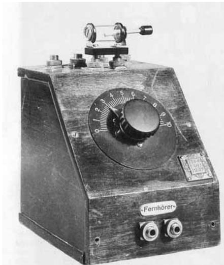
Abbildung 6.14 Detekto-Radioempfänger „Telefunken A“ von 1923 [2]
