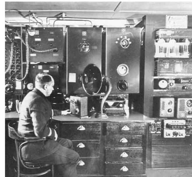
Abbildung 6.12 Der erste 1 kW-Röhrensender für Telegrafie und Telefonie, auf der „Deutschland“ [2]
